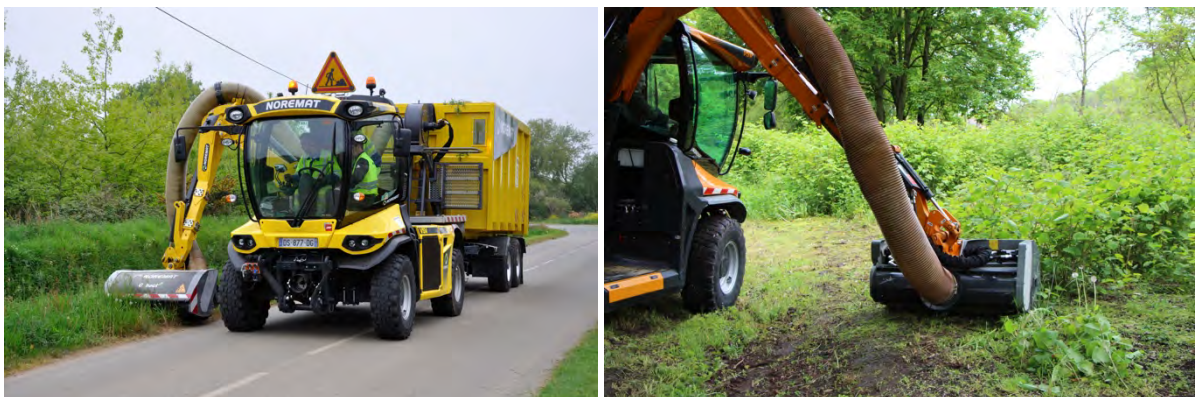
Figure 28 : Remorque aspiratrice de la marque Noremat le long d'une route et sur un site envahi par la Renouée du Japon. ©Noremat (source : www.noremat.fr ).
