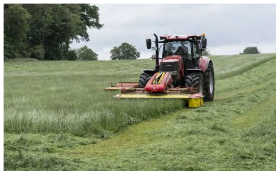
Figure 19 : Fauche avec une barre de coupe avant et latérale à disques ©Pixabay
