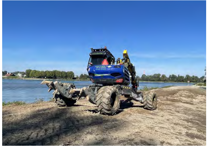
Pelle araignée sur la pointe du Kohkopf / Schreitbagger auf der Kohkopf-spitze [Photo: © Volker Späth]
